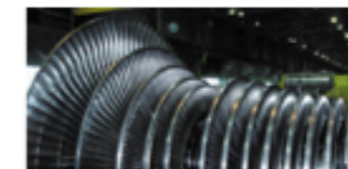
21,3 м (паровая турбина мощностью 300 МВт)
