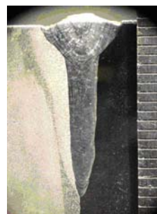
Макрошлиф сварного соединения, выполненного ЭЛС
