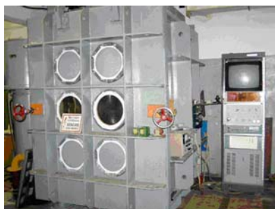
Электронно-лучевая установка ЭЛА 60/60 мощностью 60 кВт
