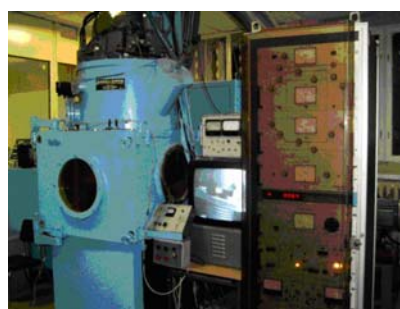
Электронно-лучевая установка Languerin мощностью 45 кВт
