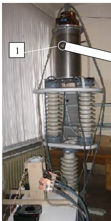
Рис. 4. Антенна радиомодема (поз.1) в установке с высокой напряженностью электрической и магнитной составляющими поля промышленной частоты
