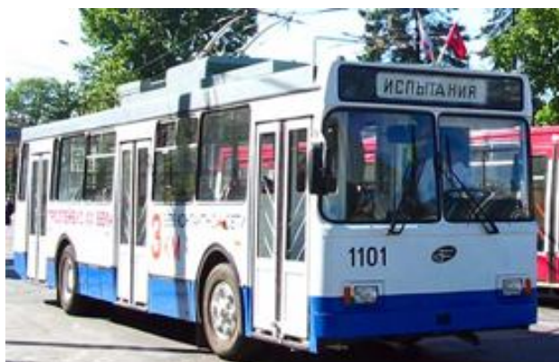
Троллейбус VM3 5298-30AX с автономным ходом 5 км
