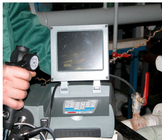
Рис.2 Внешний вид приборного оснащения для визуализации состояния внутренних поверхностей теплообменников
