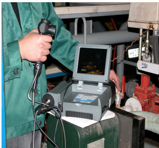
Рис.2 Внешний вид приборного оснащения для визуализации состояния внутренних поверхностей теплообменников
