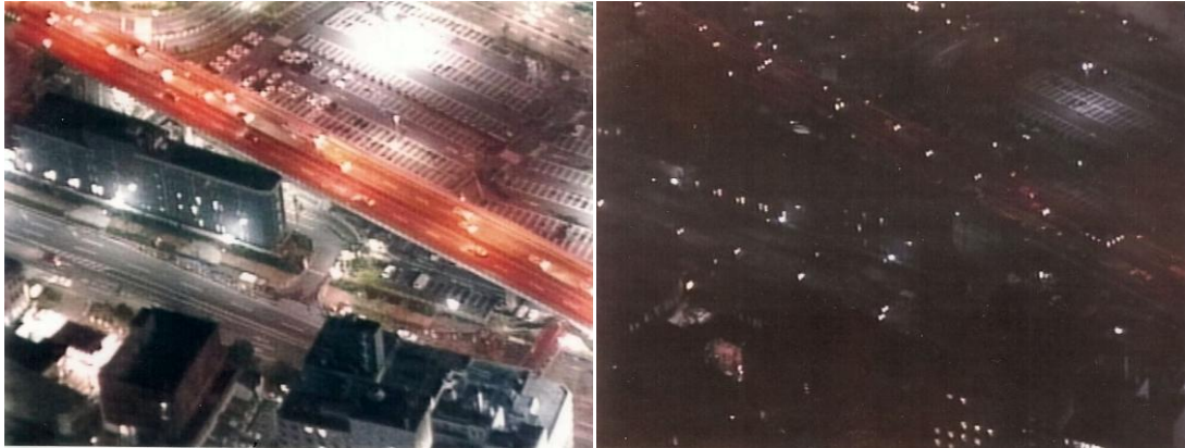
Рис. 2.15. Аэрофотографии ночного города, сделанные обычным видеоконом и видеоконом с лавинным умножением носителей заряда.
