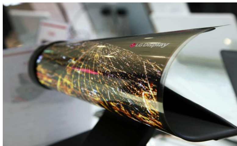
Рис. 2.35. Гибкий 45-ти сантиметровой дисплей на органических светодиодах с разрешением 1200 x 810 пикселей (LG, 2016 год).
