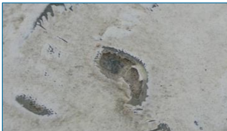
Рисунок 63. Повреждённая и острая поверхность лопасти в результате того, что пользователи ходили и играли на ней (фото: Piero Medici, 2011) [78].
