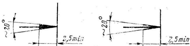
Рис. 7. Форма размерной стрелки
