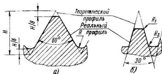
Рис. 15. Некоторые профили стандартной крепежной и ходовой резьбы: а — метрическая резьба; б — трапецеидальная резьба
