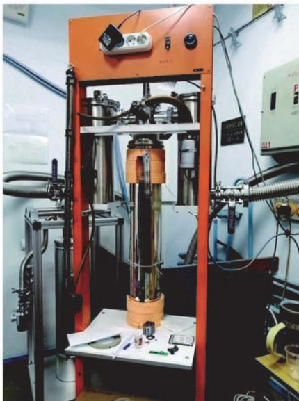
Экспериментальная установка и видеокдры пленочного кипения гелия-II внутри пористой структуры
