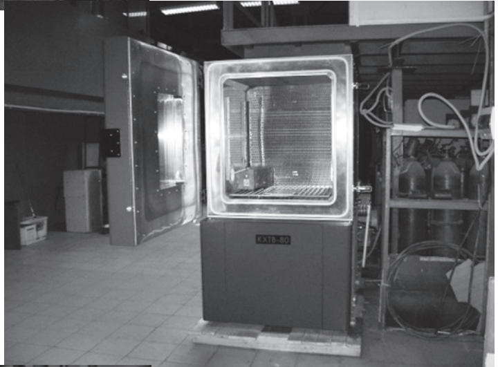
Криоцентр кафедры НТ: камера холода, тепла и влаги КХТВ-80
