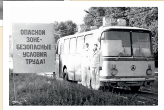
Автобус с экранированными стеклами в чернобыльской зоне.
