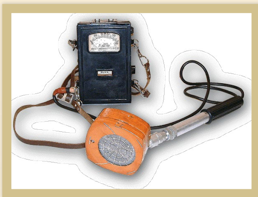
Прибор радиационного контроля КРБ-1
