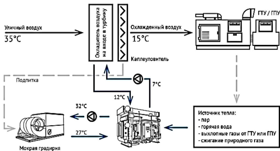
Рис. 3. Принципиальная схема энергоблока ГТУ с абсорбционным охладителем
