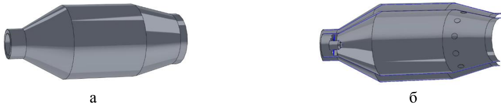
Рис. 3. Прототип конструкции камеры сгорания: а – вид 3 D, б – вид 3 D в разрезе
