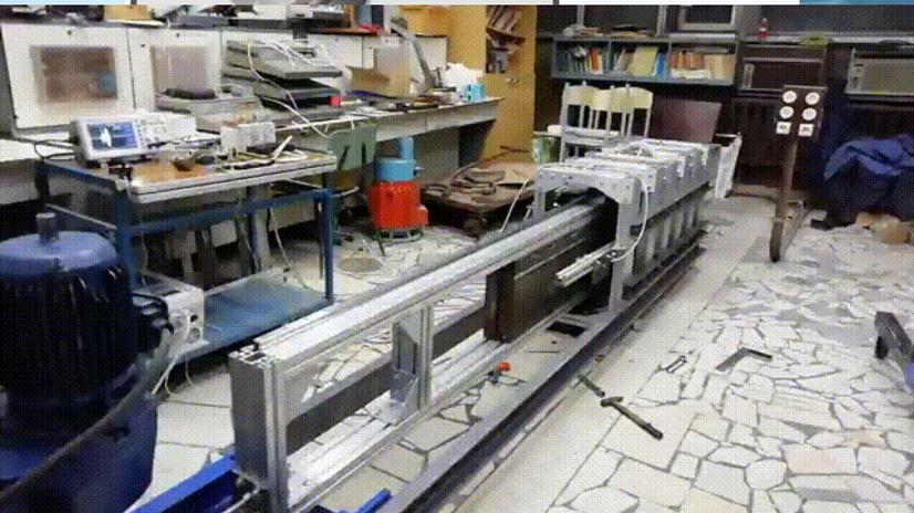
Модель низконапорной микроГЭС с сифонным водотоком
