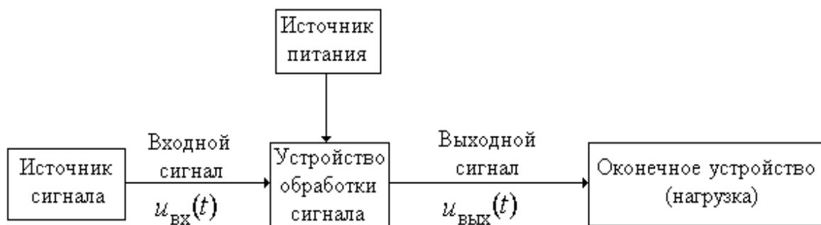
**Рис. 1.2. Структурная схема обработки сигналов.**
