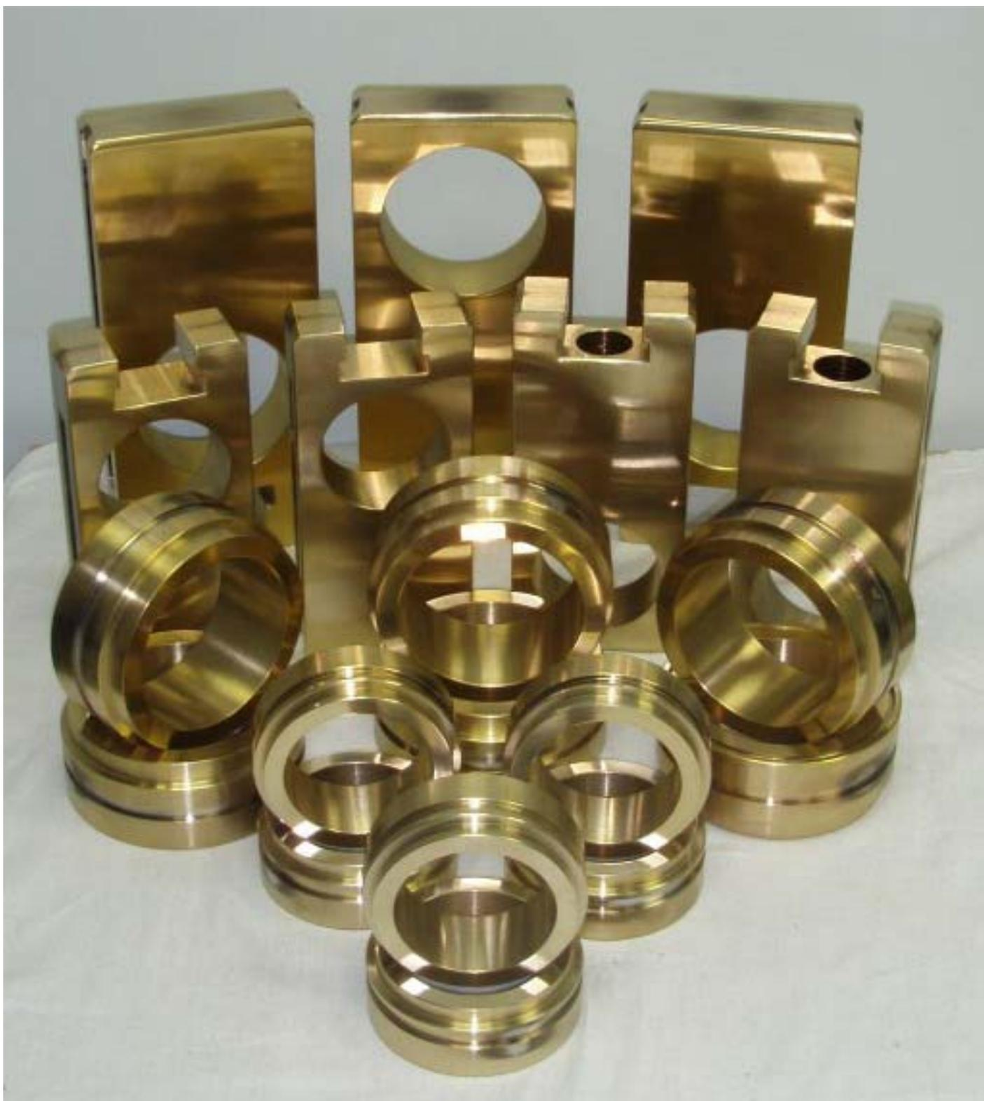
Образцы с эрозионнстойкими наноккомпозитными покрытиями
