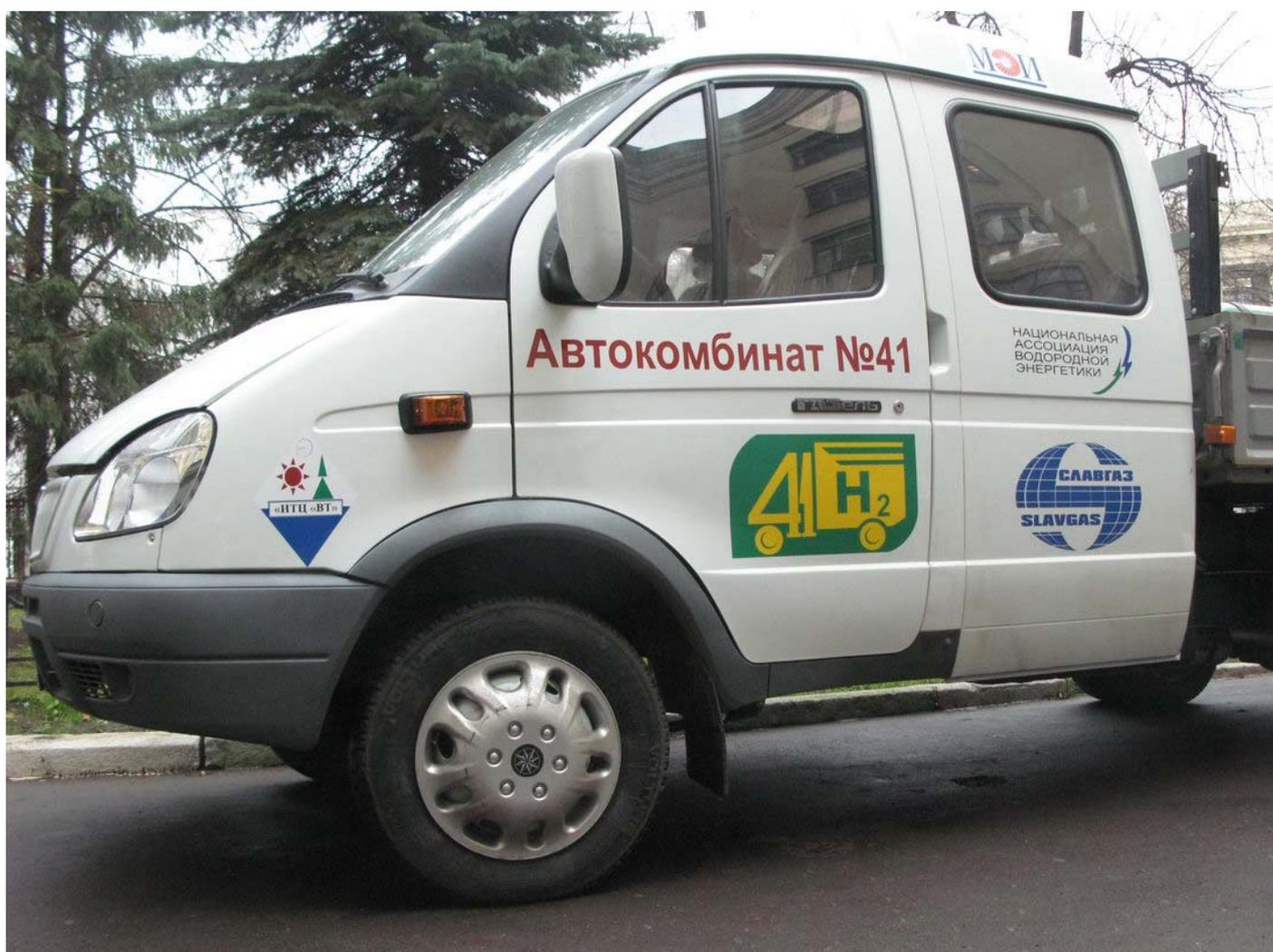
Автомобиль с гибридным бензо-водородным двигателем
