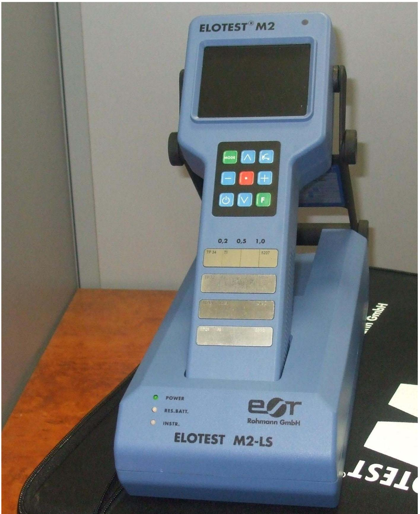
Вихретоковый дефектоскоп M2-LS
