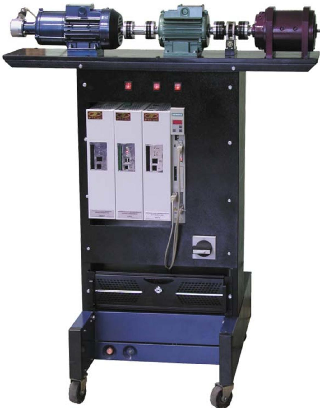
Стенд для исследования электромеханических систем с дистанционным допуском через компьютерную сеть
