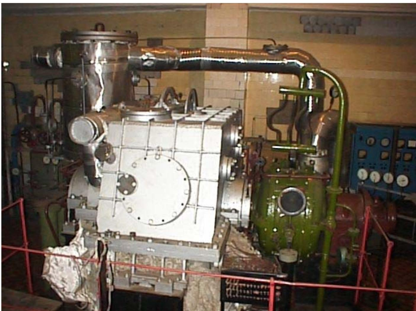
Экспериментальная турбина для исследования течения влажного пара
