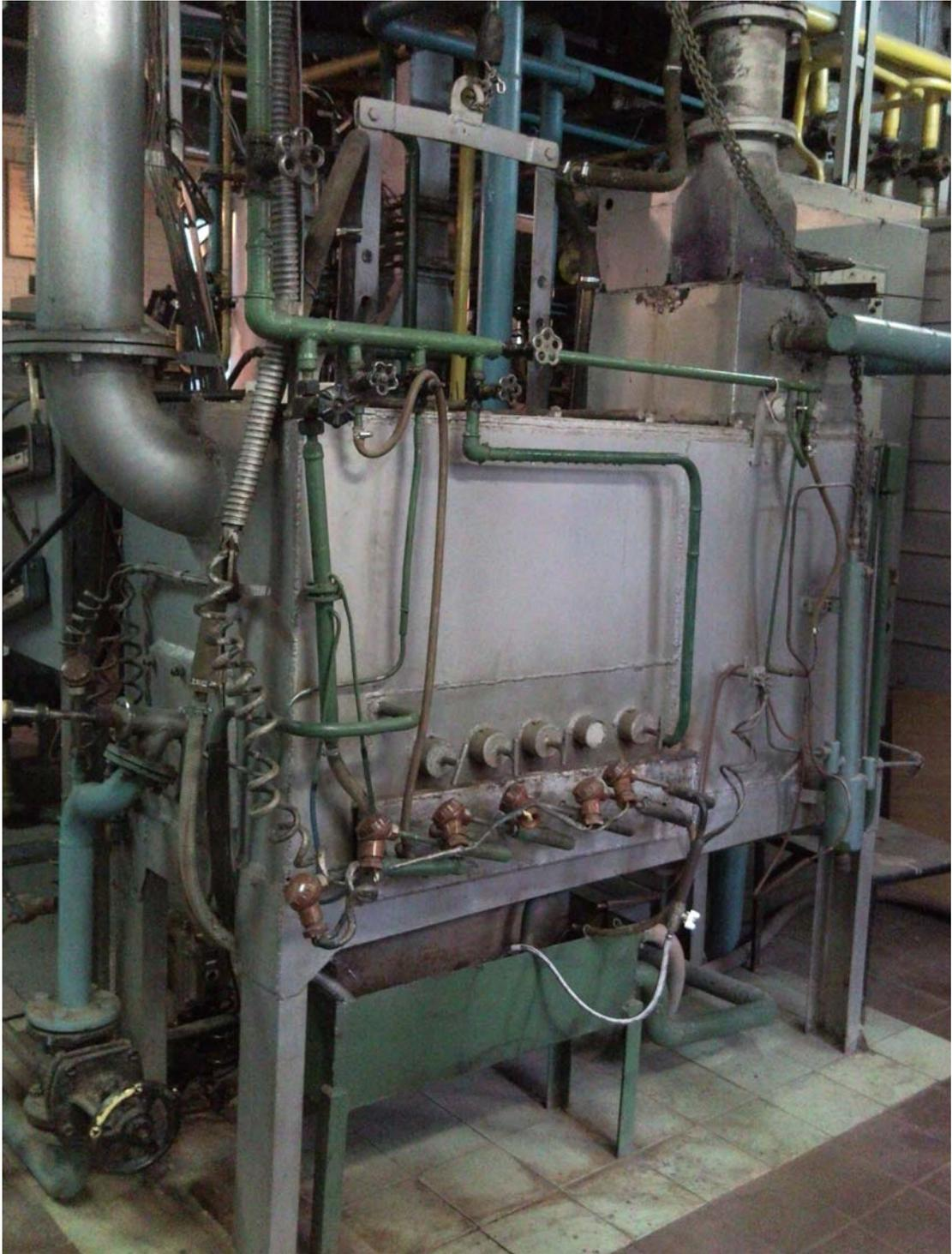
Камерная печь с излучающим факелом, каф. ЭВТ
