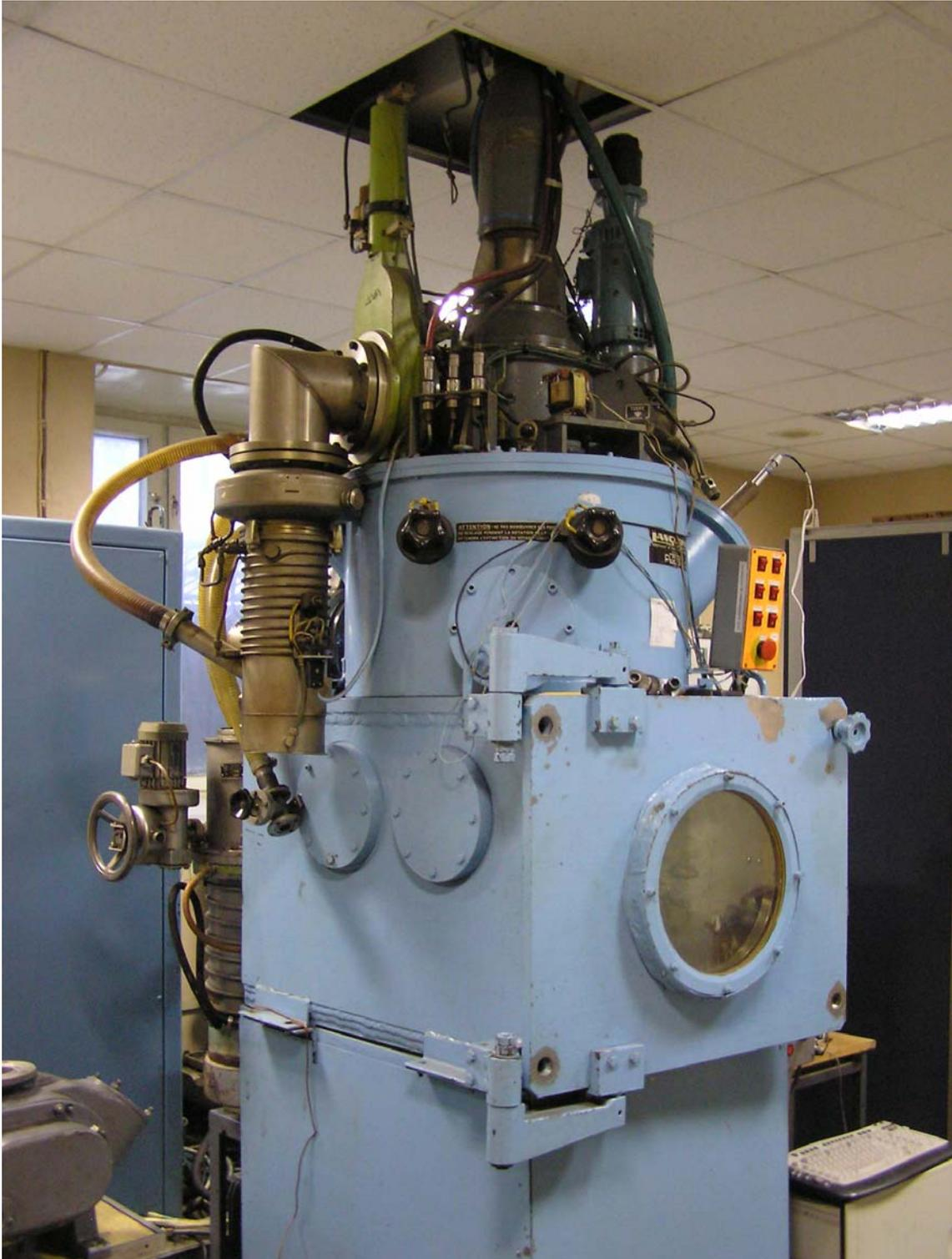
Сварочная электроннолучевая установка Langierin мощностью 45 кВт
