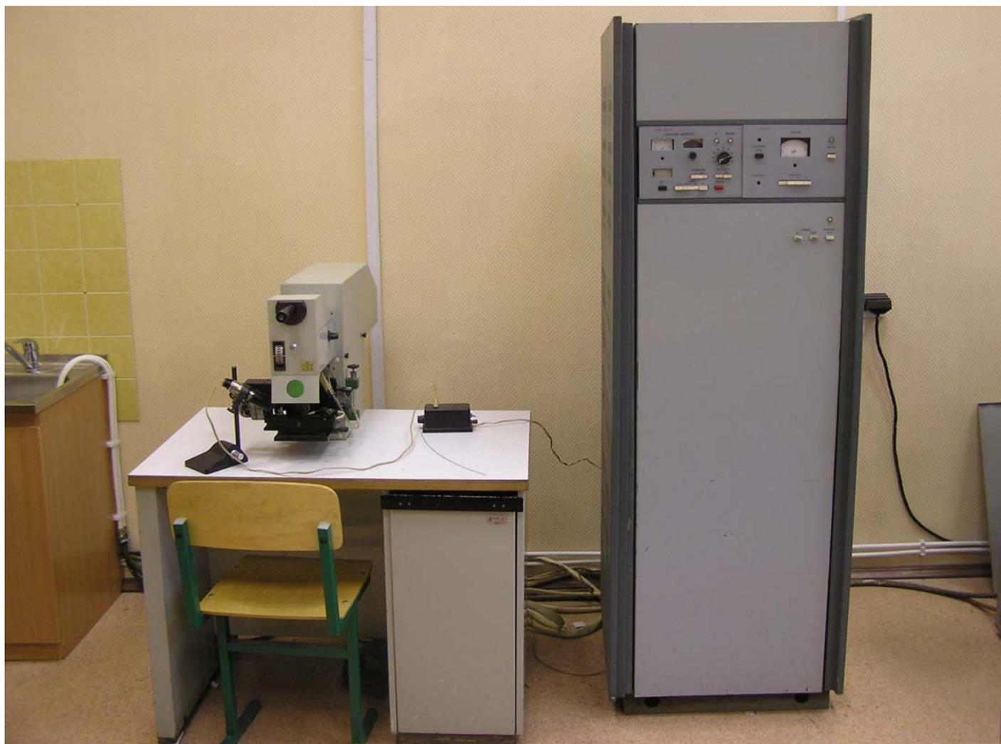
Лазерная технологическая установка «Квант 15»
