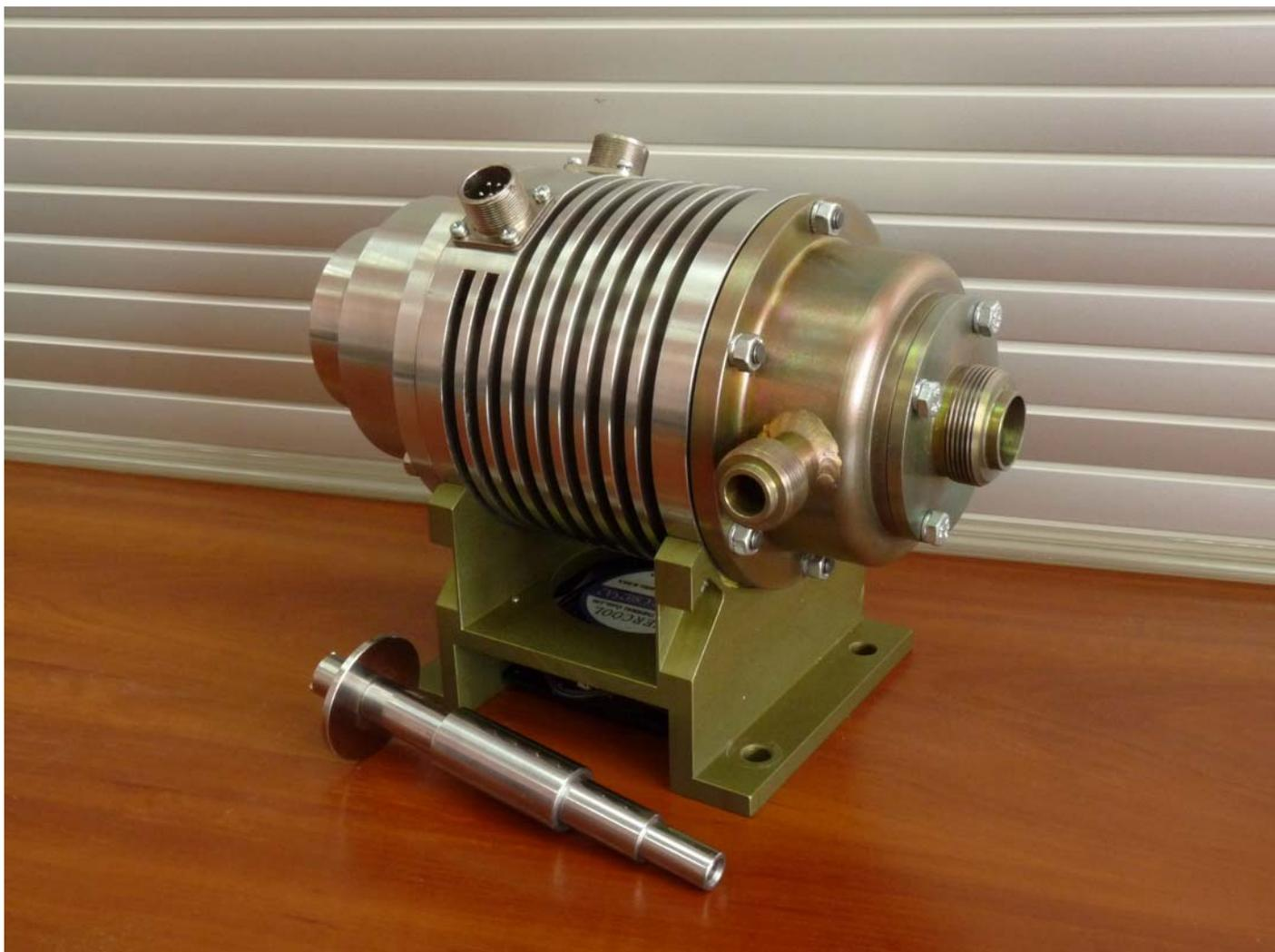
Турбогенератор работающий в органическом цикле Ренкина
