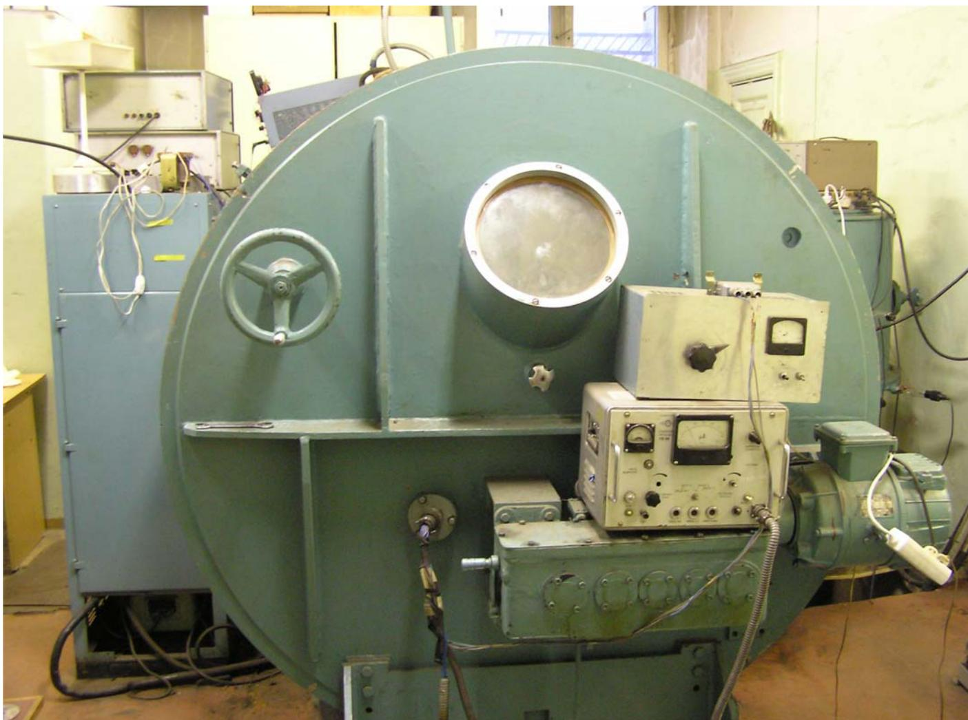
Электронно-лучевая установка «Луч-1» мощностью 15 кВт
