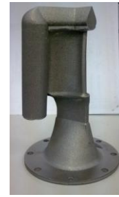
Рис. 4. Прототип, изготовленный по SLM-технологии
