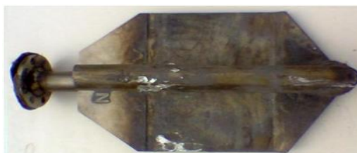
Рис. 1. Фотография модели выходной кромки после испытаний.
