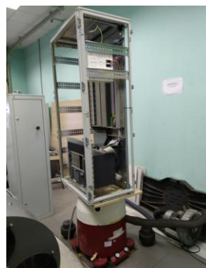
Внешний вид и осциллограмма виброиспытаний дорожного контроллера
