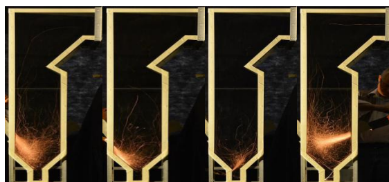
Рис.2. Траектории движения струй пылегазовой горелки (а), газомазутной горелки (б), сопла вторичного воздуха (в) и сопла третичного воздуха(г) в модели топки котла ТПП-210А, полученные при искровых продувках
