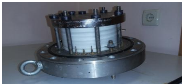
Модуль щелочного электролизера для систем позиционирования (создан коллективом Научной группы в рамках хоздоговора с РКК «Энергия» им. С.П.Королева)
