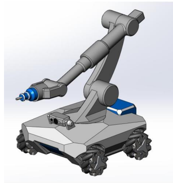
Общий вид мобильного робототехнического комплекса с шестиступенным манипулятором
