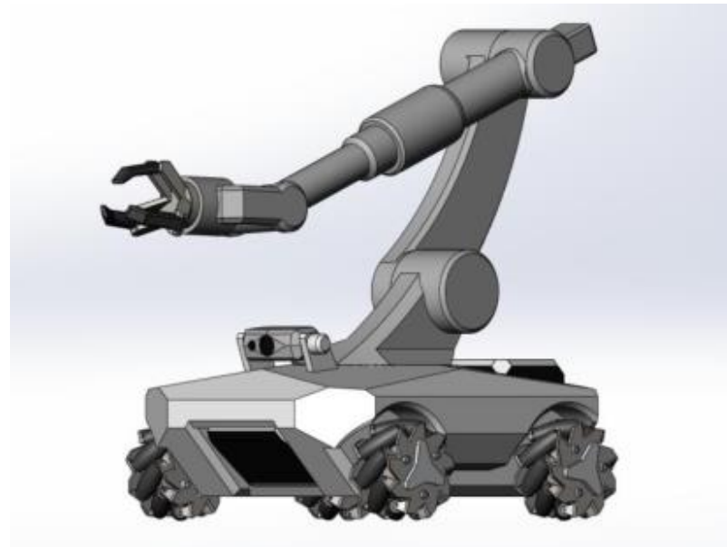
Общий вид мобильного робототехнического комплекса с захватным устройством
