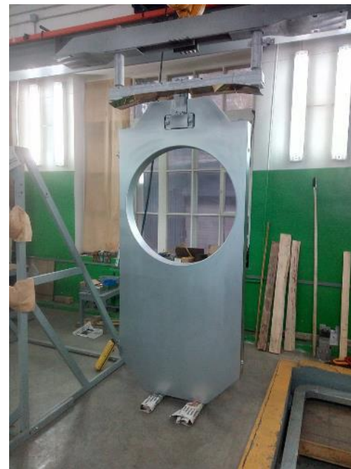
Шибер DN 1000 после формирования покрытия
