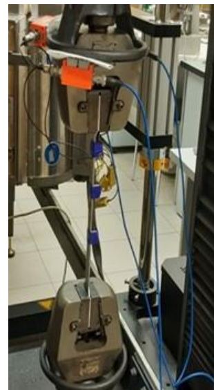
Фото экспериментальной установки (испытательная машина Instron 5982)
