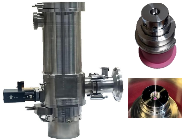
Разработанная и изготовленная электронно-лучевая пушка и её катодный узел новой конструкции
