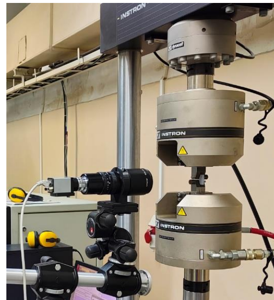
Запись изображений поверхности образца во время испытания на скорость роста трещины
