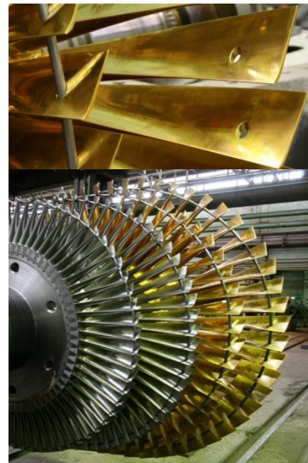
Ионно-плазменное покрытие на лопатках паровой турбины
