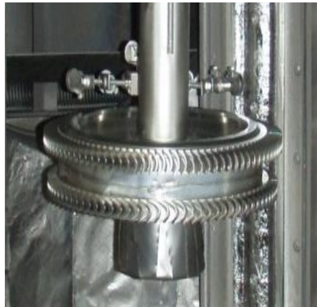
Фотоснимок диска Кертиса с жаростойким покрытием
