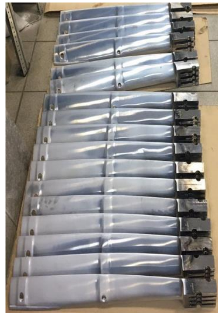
Рабочие лопатки последней ступени паровой турбины с покрытием
