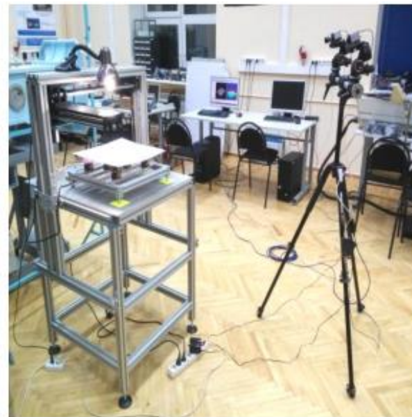
Экспериментальная установка фотограмметрической системы измерения формы и деформации поверхности на основе метода корреляции фоновых изображений
