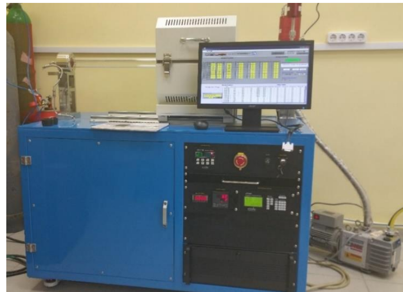
Установка PLANAR GROW, используемая для термического восстановления оксида графена
