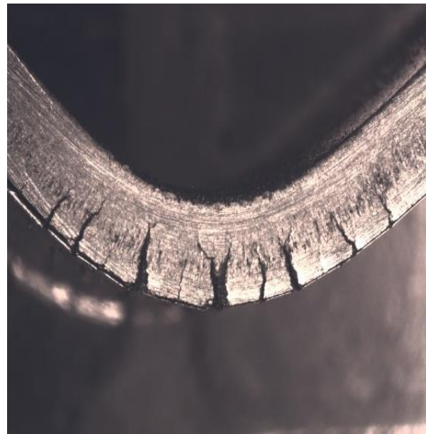
Фото образца с нанесенными стресс-коррозионными трещинами
