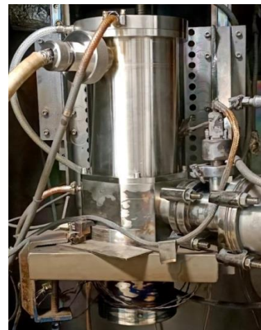
Разработанная пушка, смонтированная на электронно-лучевой установке для сварки
