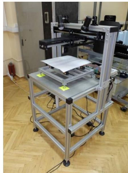
Программно-аппаратный комплекс для испытания фотограмметрических систем измерения формы поверхности и деформации.
