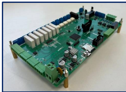
Программно-аппаратный комплекс зарядной станции электромобиля
