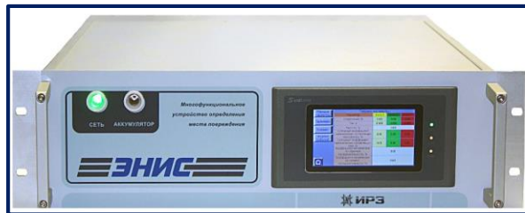
Многофункциональное устройство регистрации процессов и определения мест повреждения ВЛ 220 кВ
