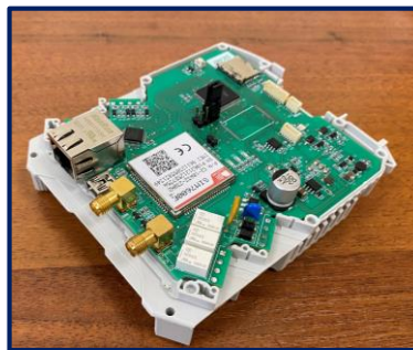
Программируемый одноплатный контроллер телемеханики PLK-C
