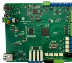
Коммуникационный контроллер PIOT-1 для интеграции объектов энергетической электроники в единую систему ДУ
