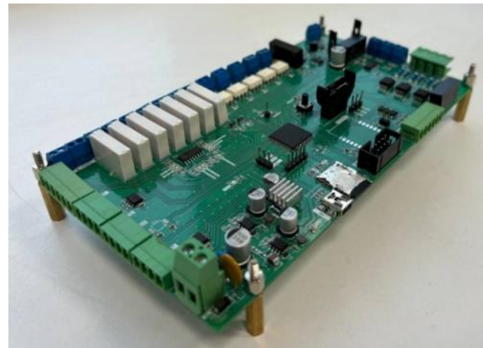
Программно-аппаратный комплекс зарядной станции электромобиля
