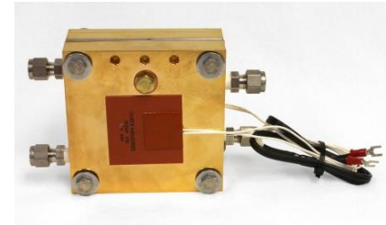
Тестовая ячейка для исследования синтезированных каталитических покрытий и мембран топливных элементов
