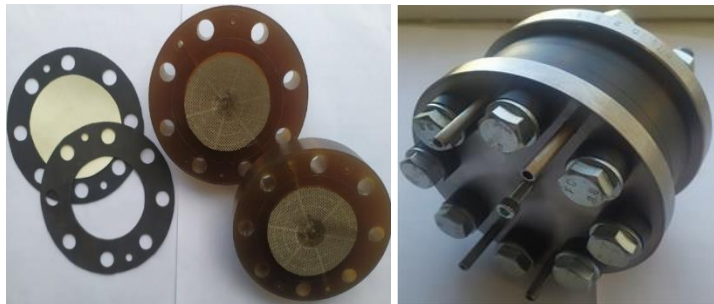
Исследовательская щелочная электролизная батарея
