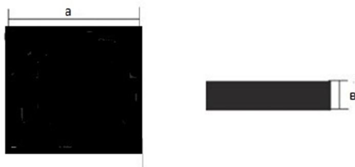
Рисунок 2 – Форма образца для исследования диэлектрической проницаемости
