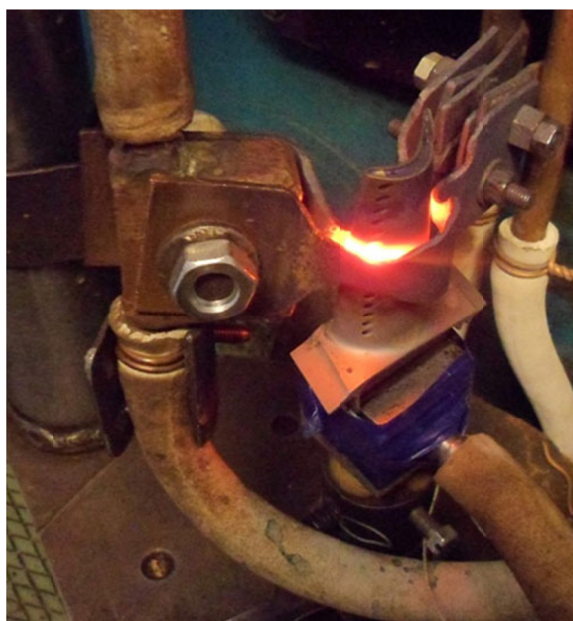
Рисунок 1 – Лопатка турбины и устройство индуктора при циклических испытаниях
