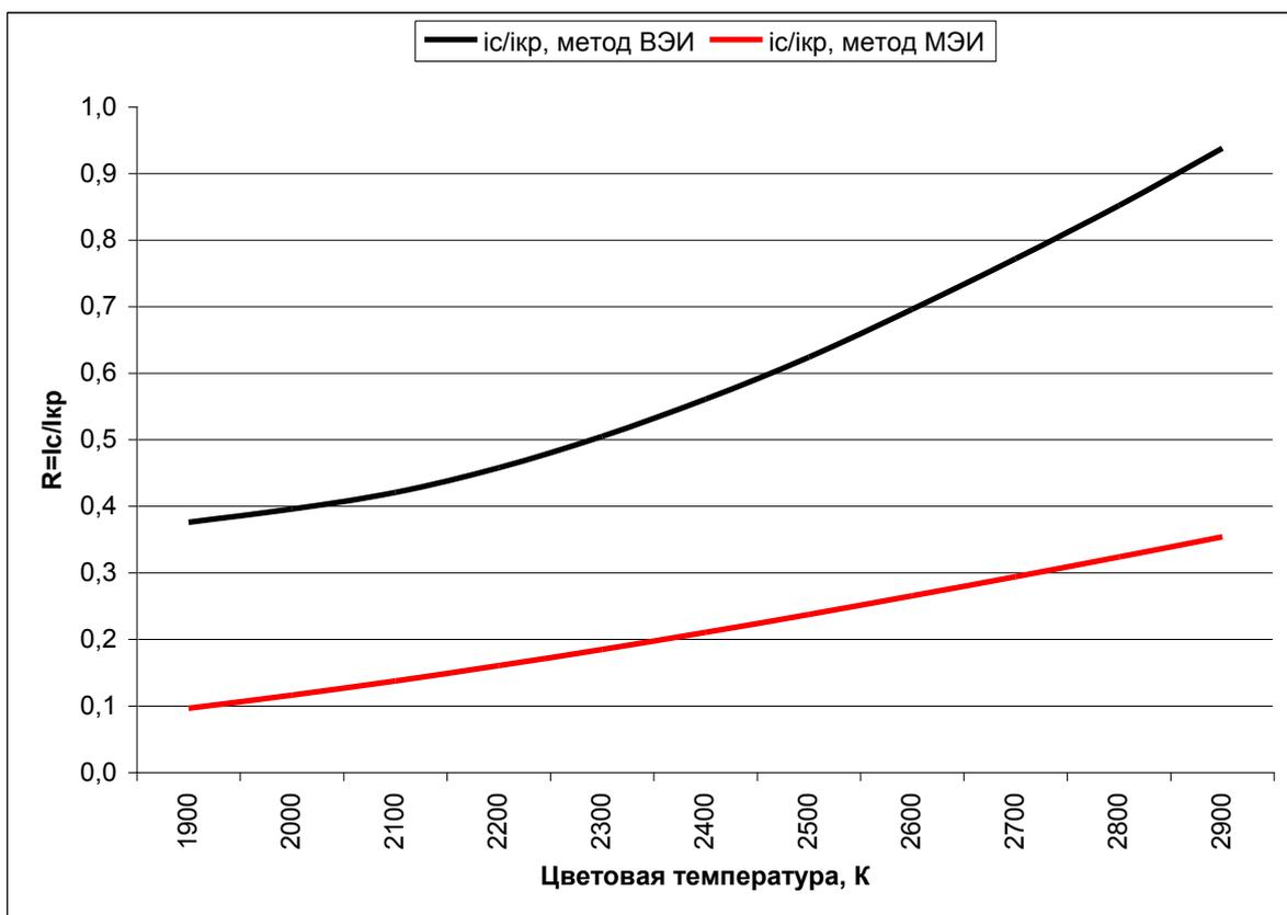
Рис.33. Зависимости  $R = i_c / i_{kp}$  от цветовой температуры
