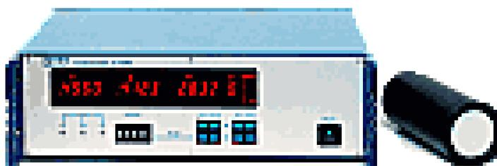
Рис. 7 Внешний вид колориметра LMT Colormeter C 1210
