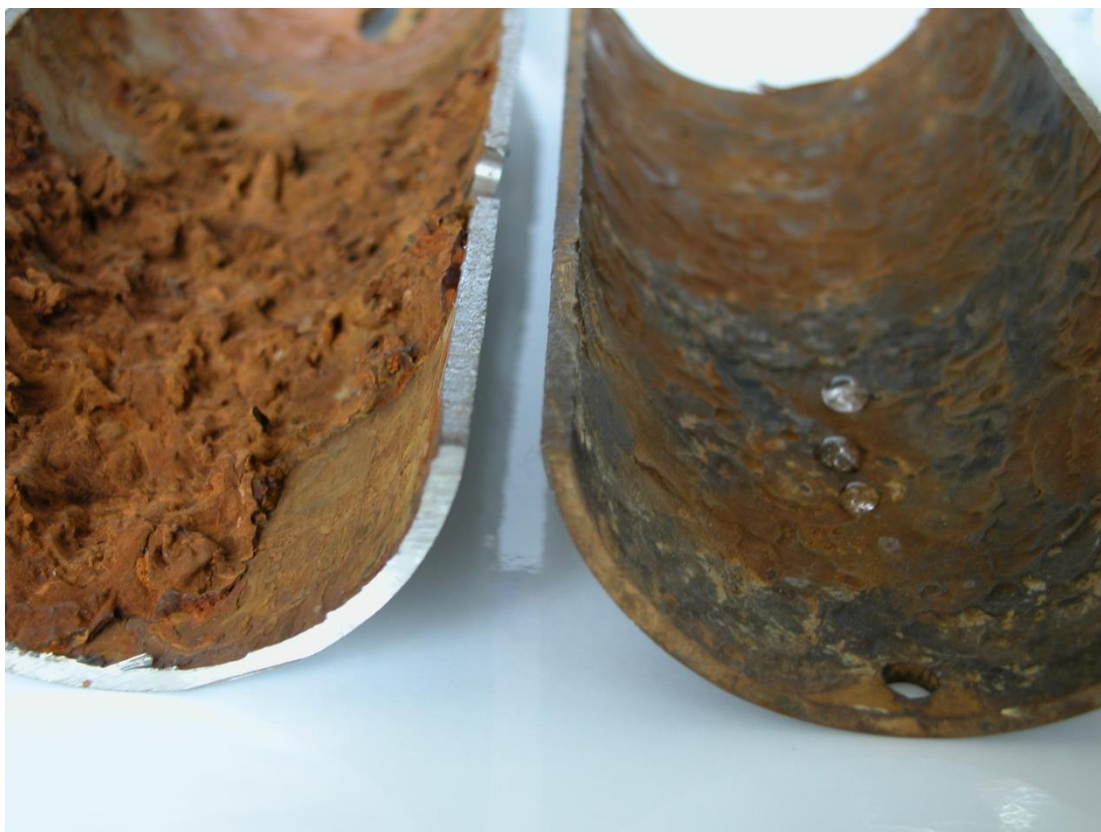
Состояние трубной поверхности до и после применения ПАВ-технологии
