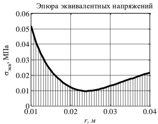
Проведем анализ напряженного состояния в опасном сечении  $r = r_1$ .
