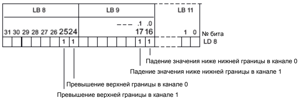
Рис. 5-6. Стартовая информация OB 40: какое событие запустило аппаратное прерывание при пересечении граничного значения
