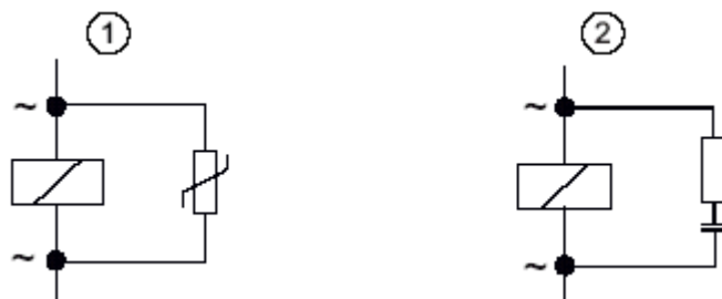
Рис. 3-3. Схемы защиты для катушек, обтекаемых переменным током
