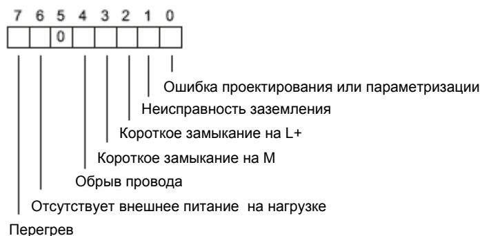
Рис. В-5. Диагностический байт для канала цифрового вывода SM 322; DO 8 x DC 24 V/0.5 A
