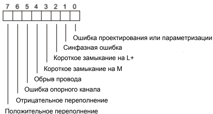
Рис. В-6. Диагностический байт для канала аналогового ввода модуля SM 331, обладающего диагностическими свойствами
