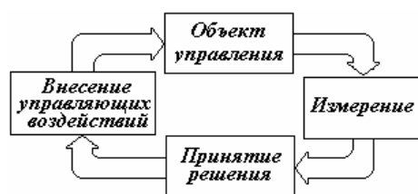
Рис. 2.2. Последовательность реализации процедуры управления
