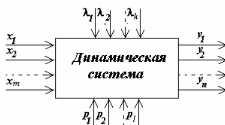
Рис. 2.1. Структурная схема динамической системы
