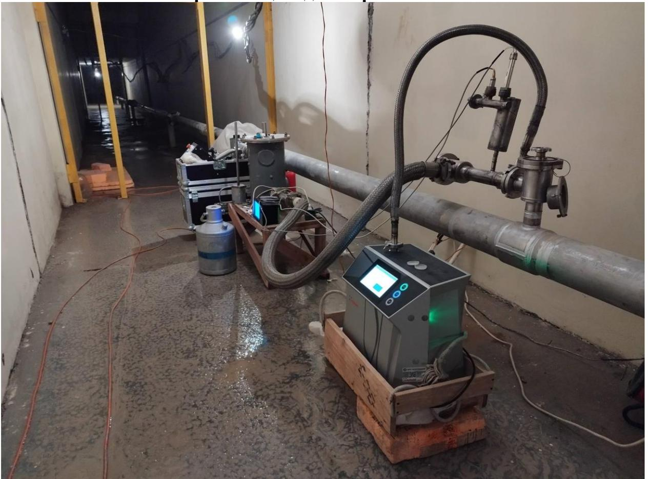
**Испытание криогенного трубопровода с помощью гелиевого течеискателя**
