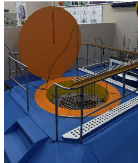
Подкритическая уран-водная сборка (схема и фотография)
