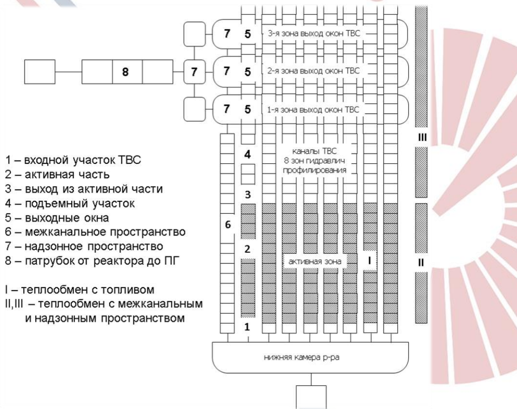
Рис. 2 - теплогидравлическая схема на основе интегрального кода Relap5
