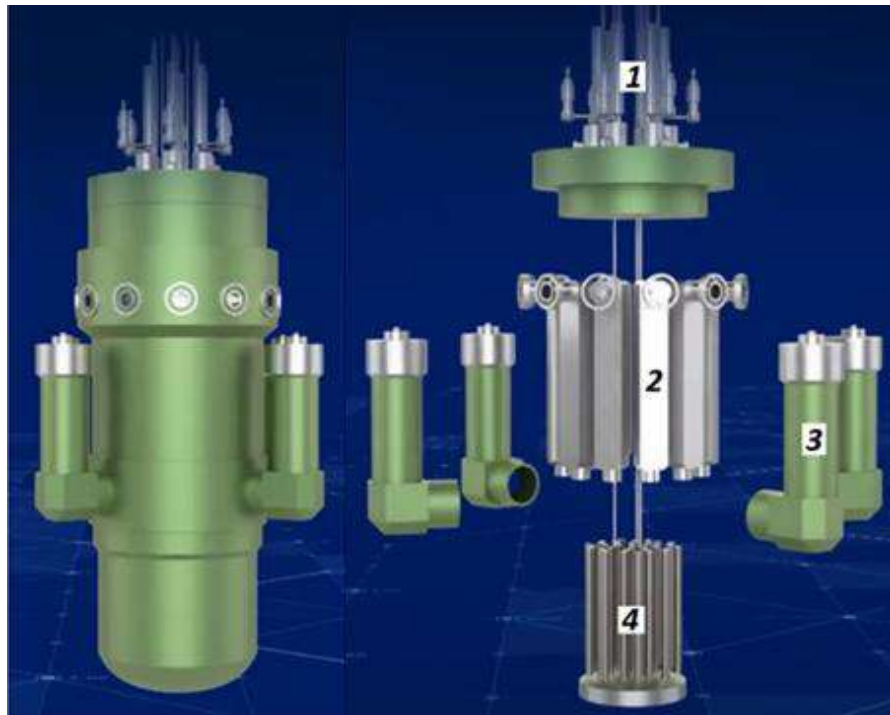
Рисунок 1. РУ РИТМ-200, 1- приводы СУЗ, 2- кассета ПГ, 3-ЦНПК, 4-АЗ
