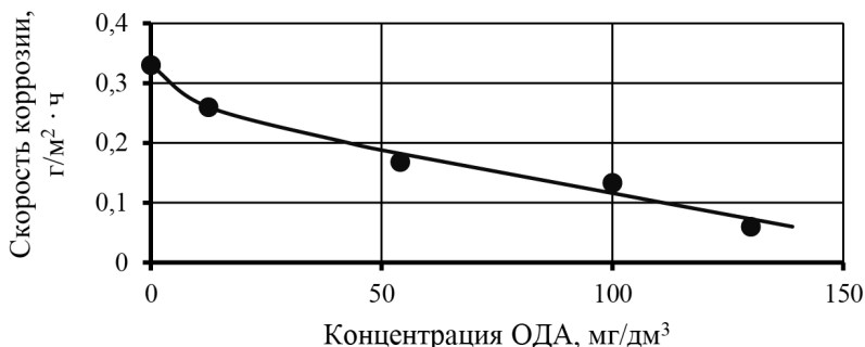
Рис. 14.5. Влияние концентрации ОДА на скорость коррозии углеродистой стали при температуре 100 °С
