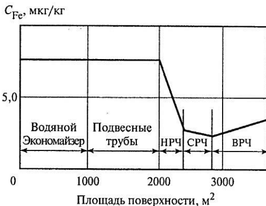
Рис. 9.5. Изменение концентрации оксидов железа по тракту котла сверхкритического давления при гидразинно-аммиачном водно-химическом режиме
